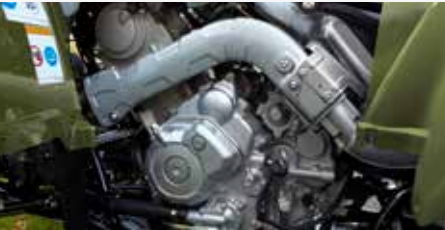
MK II SOHC-Motor mit 686 ccm Hubraum
