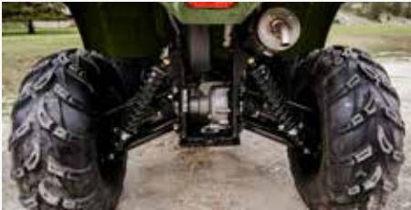
Langhubige KYB-Gasdruckstoßdämpfer vorn und hinten
