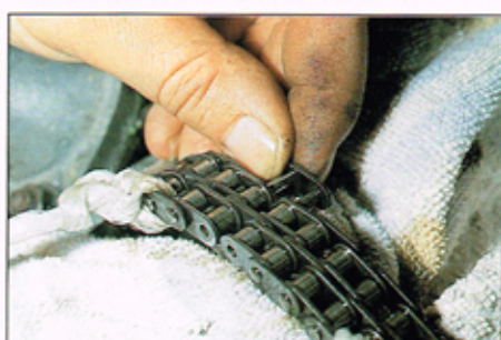
...verhindert, daß das Kettenschloß beim Öffnen in den Motor fallen kann.
