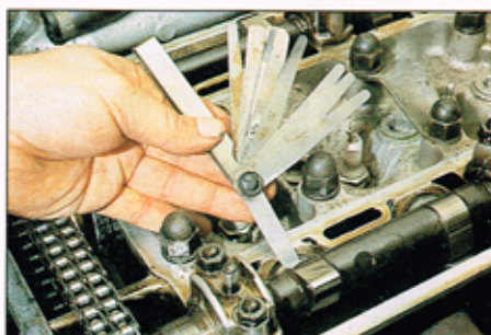
Dann wird mit Alfa-Spezialwerkzeug oder einer normalen Blattlehre das Ventilspiel gemessen...
