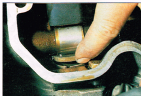
...um an die Einstellscheibe zu gelangen, die auf dem Stößel liegt. Die Nockenwellen bleiben drin!
