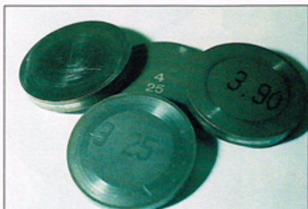
Die Fiat-Einstellscheiben sind größer und schwerer als die von Alfa – nur im Rennsport spürbar.
