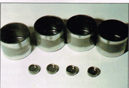
Die kleinen Distanzhütchen (vorn) sind für die Ventileinstellung verantwortlich.
