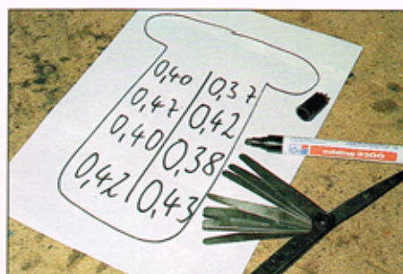
...und notiert. Anhand dieser Werte werden später die richtigen Einstellscheiben errechnet.
