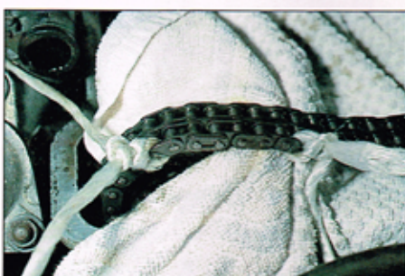
Steuerkette mit einem Band sichern, damit sie nicht in den Motor fallen kann. Ein Lappen...
