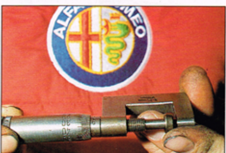
Die alten Hütchen werden vermessen, um anschließend die Stärke der neuen zu errechnen.
