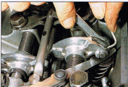
Auch hier übernimmt ein kleiner Exzenter am Kipphebelende die Einstellung.
