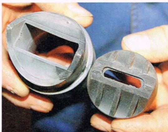
Die Öffnung des Innenwinkel-Mundstücks links ist zu groß für viele Karosseriefalze
