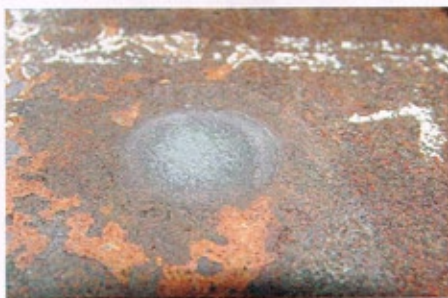
Es wirkt: In Sekunden legten alle Pistolen das stark korrodierte Blech punktuell blank
