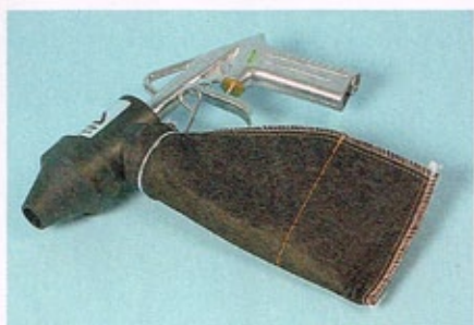
Weiche Mundstücke (li.) schmiegen sich ans Werkstück und lassen kaum Staub entweichen
