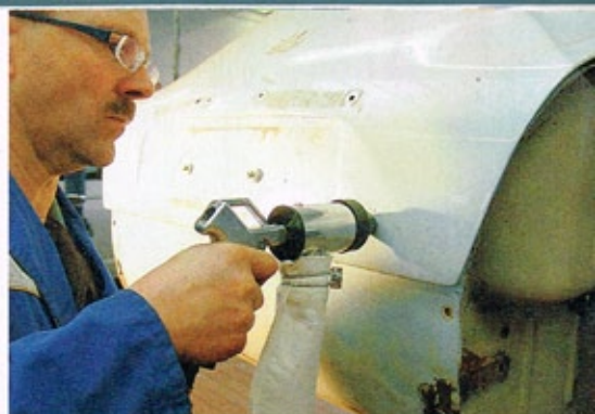
Idealer Einsatzzweck: Ein unterrosteter Steinschlag lässt sich mit den Pistolen...
