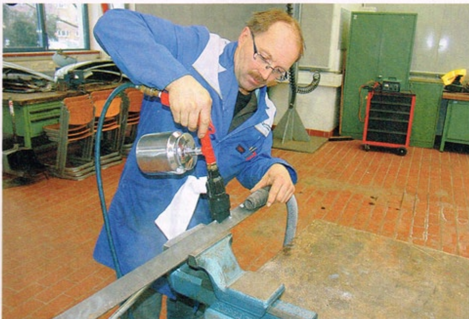
Effizienz beim Strahlen und die Größe der gestrahlten Fläche ermittelten wir auf einer stark verrosteten Blechtafel, die Mundstücke testeten wir an einem Stahlwinkel innen und außen
