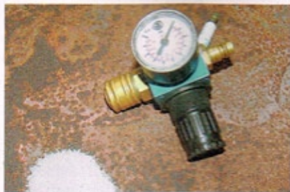
Für gleiche Chancen sorgten einheitliches Strahlgut und ein geeichter Druckminderer
