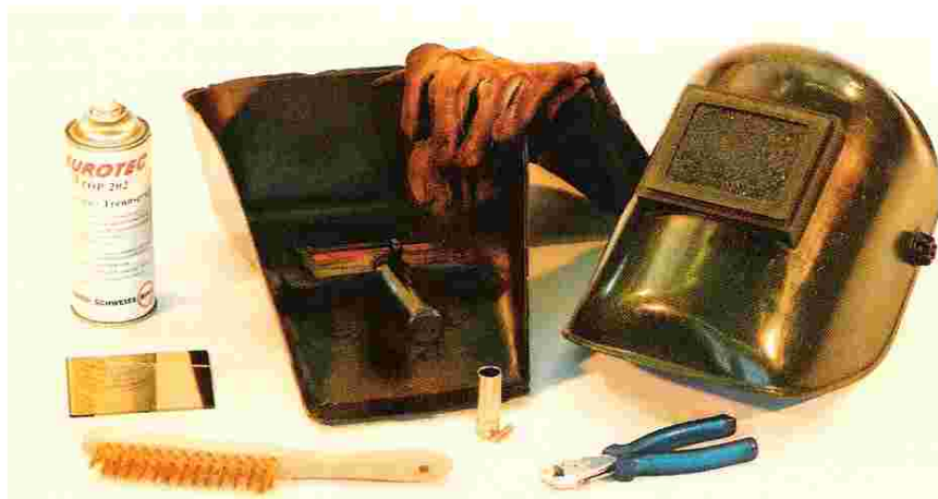
Grundausstattung: Neben Gerät und Flasche bedarf es eines Paares Schweißerhandschuhe, Schweißschild oder -helm, Reinigungsspray für den Brenner sowie Ersatzstrom- und -gasdüse
