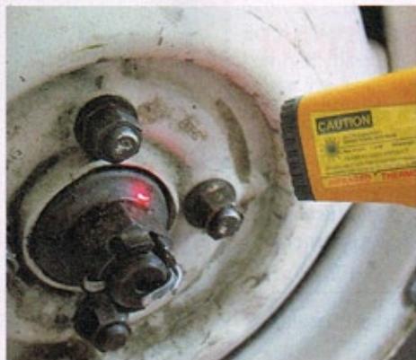
Auch der Zustand von Radlagern lässt sich mit einem IR-Thermometer überprüfen. Werden sie zu heiß, ist ihr Lebensende meist nah
