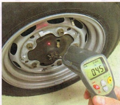
Nach Bergabfahrt geben die Temperaturen der Trommeln Aufschluss über deren Funktion. Die vorderen müssen heißer als die hinteren sein
