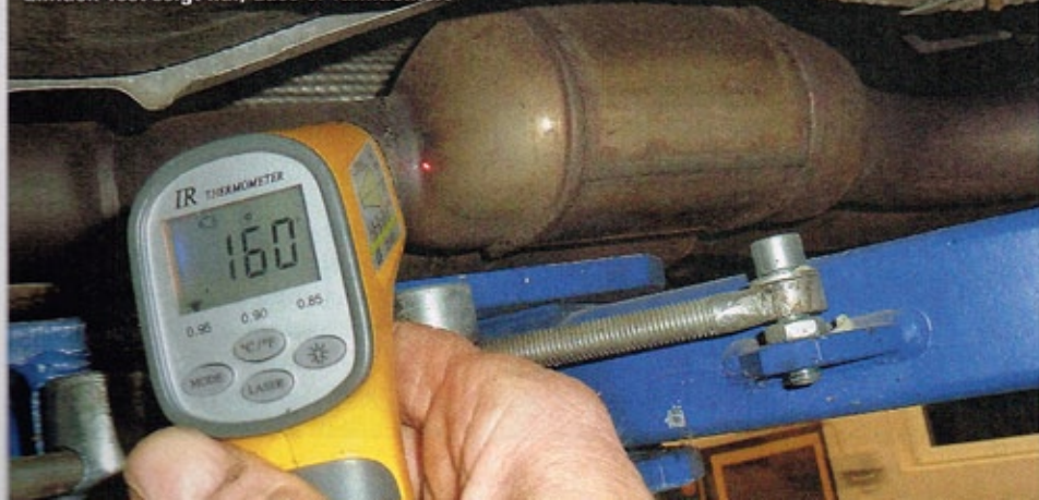
Nach rund drei Minuten soll der Kat am Auslass deutlich heißer als auf der Einlassseite sein. Der Einfach-Test zeigt nur, dass er funktioniert
