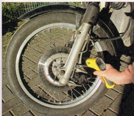
Dieser Schwingsattel neigt zu Schwergängigkeit. Fünf Kilometer nach einer Bergabfahrt sind die Temperaturen wieder auf normal – alles ist gut
