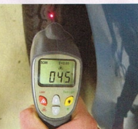
Wenn nach flotten Runden ein Reifen wesentlich wärmer als der der Gegenseite ist, liegt es an fehlender Luft oder an einem Karkassenschaden
