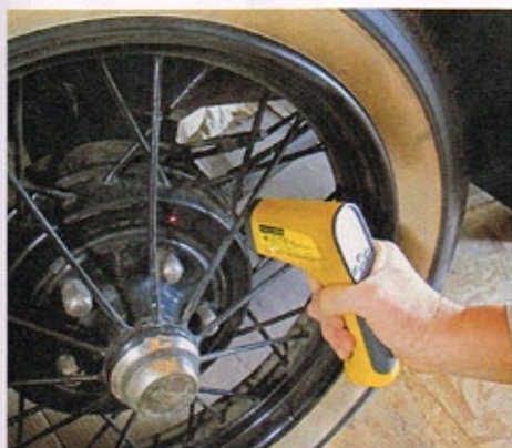
Ob die Bremsen vollständig lösen, zeigt die Messung nach längerer Geradeausfahrt. Dazu das Fahrzeug bis zum Stillstand ausrollen lassen
