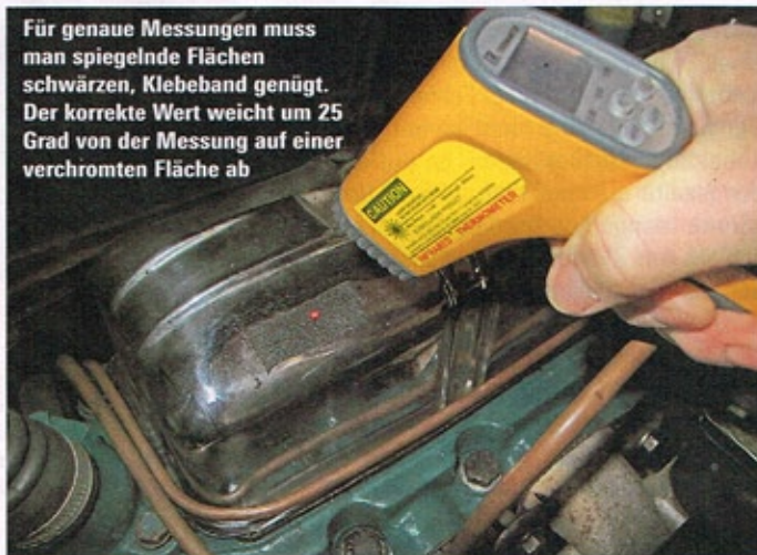
Filtert der Nebenstrom? Hier zeigt sich, ob der nachträglich eingebaute Ölfilter wunschgemäß Dienst tut
