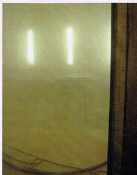
Dicke Luft: Eine durchsatzfreundige Absauganlage gehört zur Grundausstattung jeder professionellen Trockenstrahlkabine
