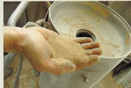
Soda – so sieht's aus: Auch Sodastrahlmittel ist in verschieden großer Körnung erhältlich
