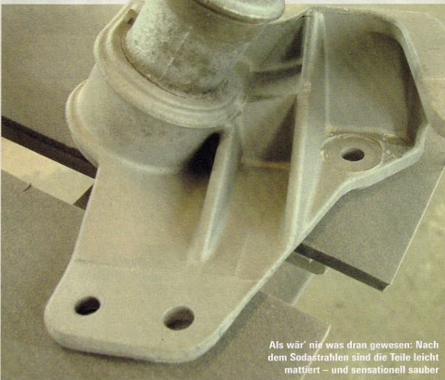
Soda sanft: Auch für das Strahlen von Technikteilen ist das Material gut geeignet
