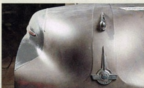
Bemerkenswert glatte Motorhaube: Kunststoff-strahlen ist teuer, im Ergebnis aber überzeugend
