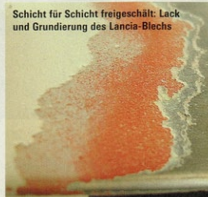
Da ist der Lack nicht ab: Die Lackierung der Lancia-Motorhaube ist spröde und rissig
