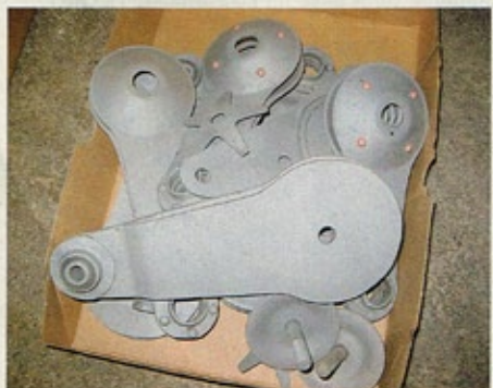
Unterrostete Teile wie diese Reibungs-Stoßdämpfer sind ganz klar ein Fall fürs Grobe
