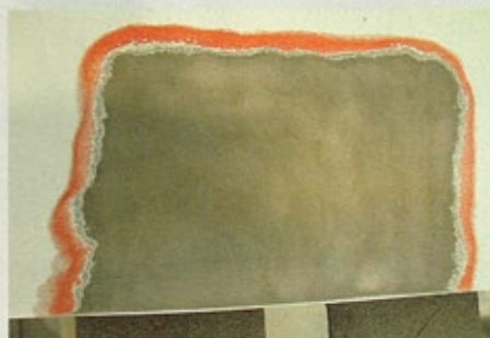
Blank im Schonverfahren: Die gestrahlte Haube behält sogar ihre originale Phosphatierung
