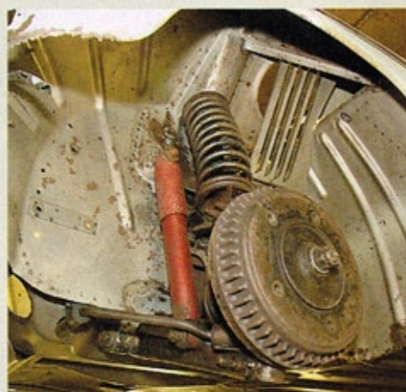
Anstelle der hartnäckigen Bitumenschicht glänzt am Ende mehr oder minder schönes Blech
