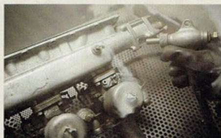
Empfehlenswert insbesondere für verunreinigte Technik-Komponenten: das Glasperlenstrahlen
