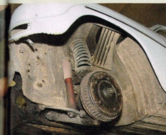
Im Radhaus dieses 50 Jahre alten Saab zeigt die Trockeneis-Therapie eindrucksvoll, was sie kann
