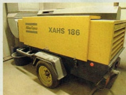
Ordentlich Druck auf'm Kessel – mit solch einem dieselgetriebenen, 140 PS starken Baukompressor kein Problem!
