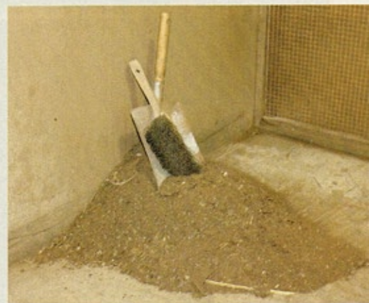
Was vom Spektakel bleibt: abgestrahlter Unterbodenschutz in besenfeiner Form
