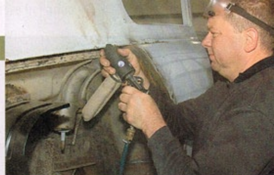
Weiche Mundstücke passen sich auch kantig geformten Oberflächen an
