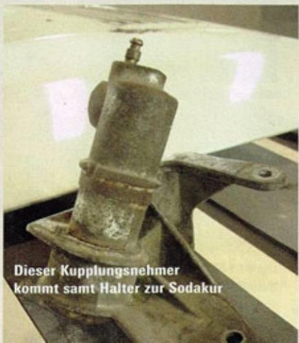
Soda sanft: Auch für das Strahlen von Technikteilen ist das Material gut geeignet
