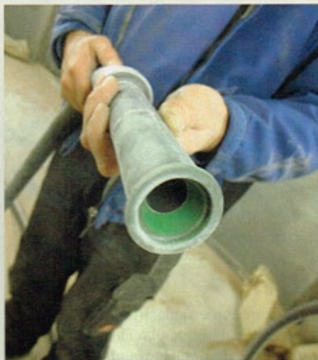
Die Düse machen: Für jeden Einsatzzweck hat der Profi entsprechende Strahldüsen in verschiedenen Durchmessern parat
