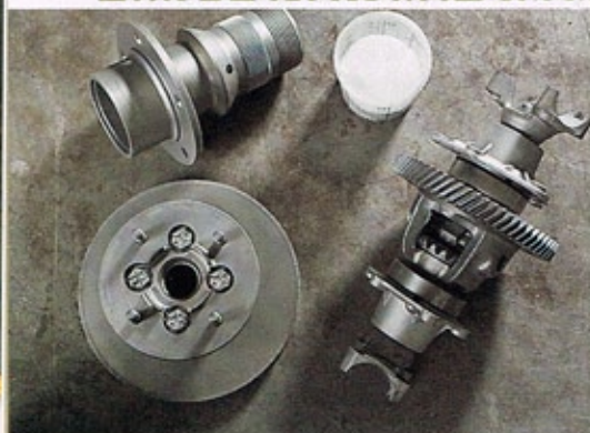
Empfehlenswert insbesondere für verunreinigte Technik-Komponenten: das Glasperlenstrahlen
