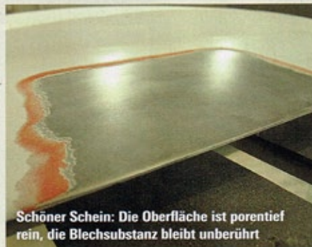
Blank im Schonverfahren: Die gestrahlte Haube behält sogar ihre originale Phosphatierung
