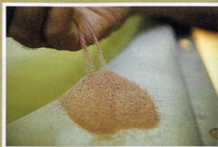
Wenn der Name Programm ist: Beim klassischen Sandstrahlen verwenden Profis heute Granatsand statt des gesundheitsschädlichen Quarzsands
