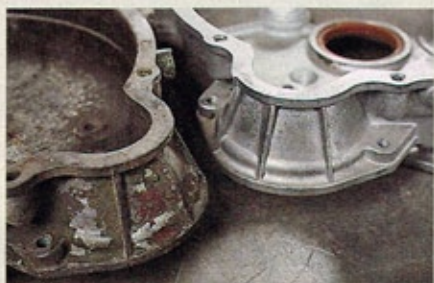
Soda sanft: Auch für das Strahlen von Technikteilen ist das Material gut geeignet
