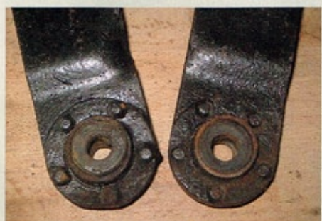
Unterrostete Teile wie diese Reibungs-Stoßdämpfer sind ganz klar ein Fall fürs Grobe
