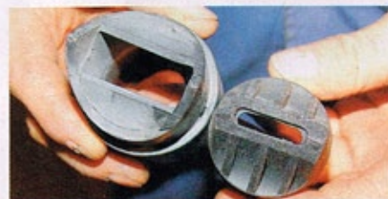
Für Arbeiten an Karosriefalzen gibt es speziell geformte Gummi-Mundstücke
