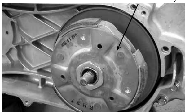
Clutch/Driven Pulley
