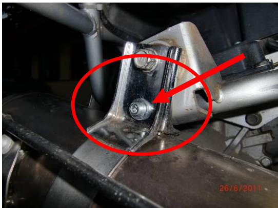
Schelle mit einer Schraube M6x 25 geklemmt!
