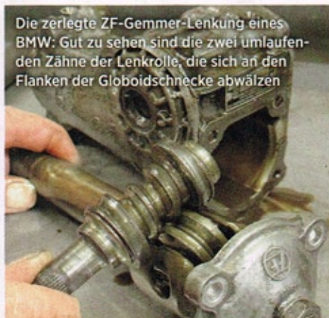
Obwohl die Bauteile sehr massiv gefertigt sind, zeigt sich an den Flanken schon Verschleiß
