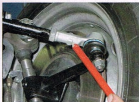
Sicher ist sicher: Kontrollieren Sie unbedingt auch die Staubschutzmanschetten auf Risse
