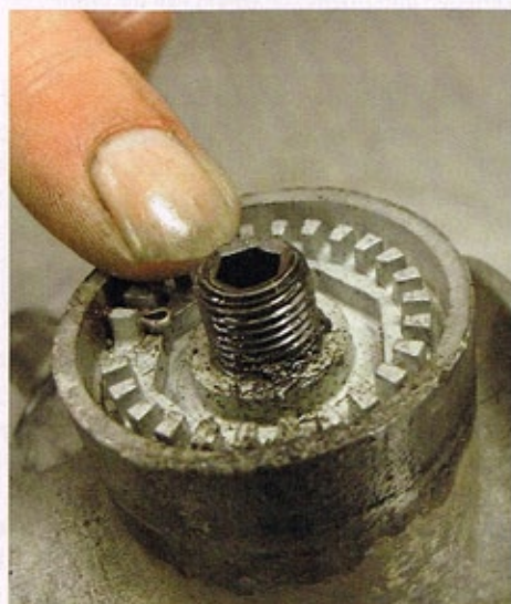
Grundsätzlich empfiehlt es sich, das Spiel am Lenkgetriebe erst dann einzustellen, wenn alle Fahrwerksteile kontrolliert worden sind
