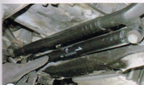
4 Schon der Käfer hatte einen Lenkungsämpfer – der sich leicht erneuern lässt
