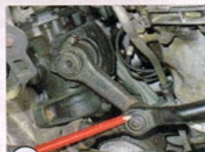
2 Bei dieser Konstruktion anfällig: Die Gelenke der mittleren Spurstange
