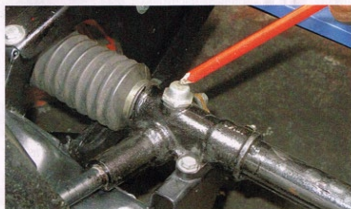
Mit der Fettpresse gegen den Verschleiß: Regelmäßiges Abschmieren von Fahrwerkskomponenten gehört nicht nur bei alten Engländern zum guten Ton
