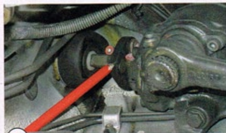
5 Die Gummi-Gelenkscheibe in der Lenksäule wird nur selten beachtet
