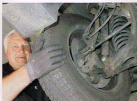
So ist's richtig: Am entlasteten Rad lässt sich leicht prüfen, ob der Spurstangenkopf okay ist
