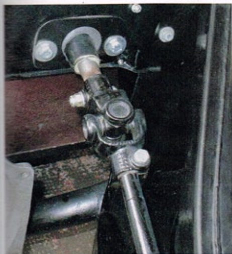
Das klassische Kreuzgelenk in der Lenksäule ist als Schwachpunkt schnell auszumachen – aber leider nicht immer besonders gut zugänglich...
