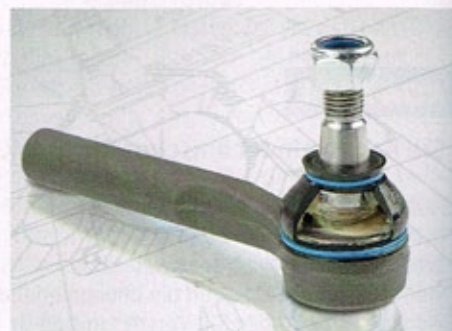
Die wartungsfreien Stahl-Kugelköpfe sind mit Fettfüllung in eine Kunststoffschale eingebettet
