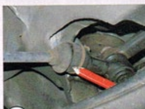
1 Fast immer die ersten Verdächtigen: Die Kugelenke der Spurstange
