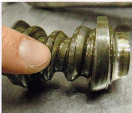
Obwohl die Bauteile sehr massiv gefertigt sind, zeigt sich an den Flanken schon Verschleiß
