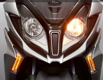
Große Doppelscheinwerfer mit umlaufendem LED-Leuchtbands
