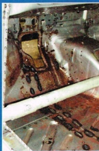
Rost wird erst deutlich sichtbar und dann im Phosphorsäurebad entfernt
