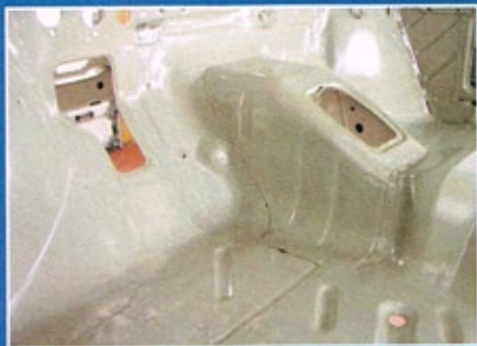
Nachher: Dieselbe Stelle nach Einsatz der KTL. Der Fußraum präsentiert sich makellos
