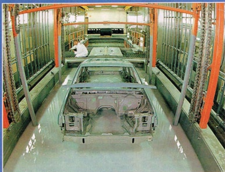
Das Verfahren selbst ist gut 40 Jahre alt, wurde aber im Lauf der Zeit immer weiter verbessert. Anfangs versuchte es Ford in den USA mit Anoden-Tauchlackierung
