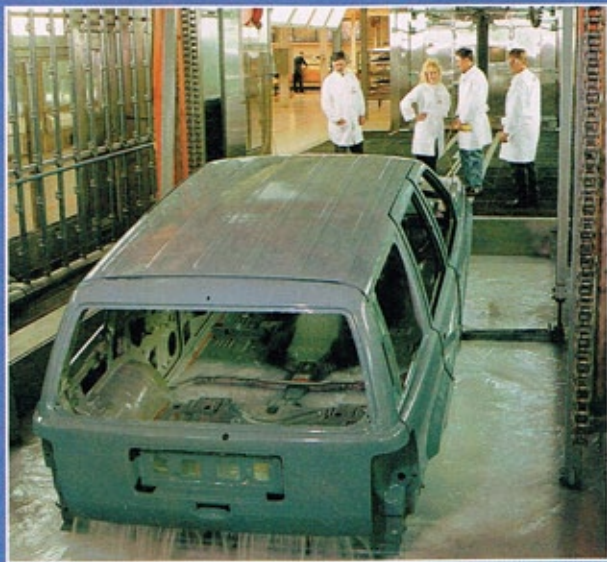
Beim Verlassen des Bades zeigt sich eine gleichmäßige Beschichtung, die bis in den kleinsten Winkel der Karosserie reicht
