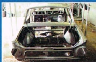
Letzte Ablagerungen werden mit dem Hochdruckreiniger beseitigt
