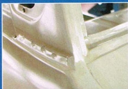
Das schafft kein noch so feiner Pinsel: Die Grundierung dringt in jeden Spalt vor
