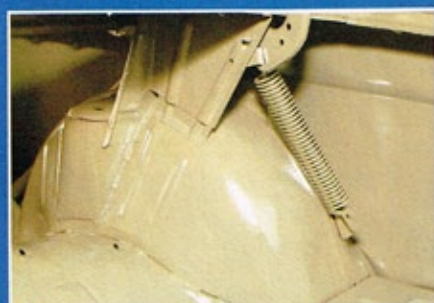
Sogar die Spannfeder am Scharnier der Kofferraumklappe ist deckend beschichtet
