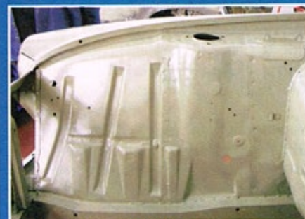
Die Grundierung sollte nicht mehr angeschliffen werden, sonst schaut schnell das Blech durch
