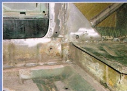
Als Rennauto erhielt das Restaurationsobjekt noch weitere innere Verstärkungen
