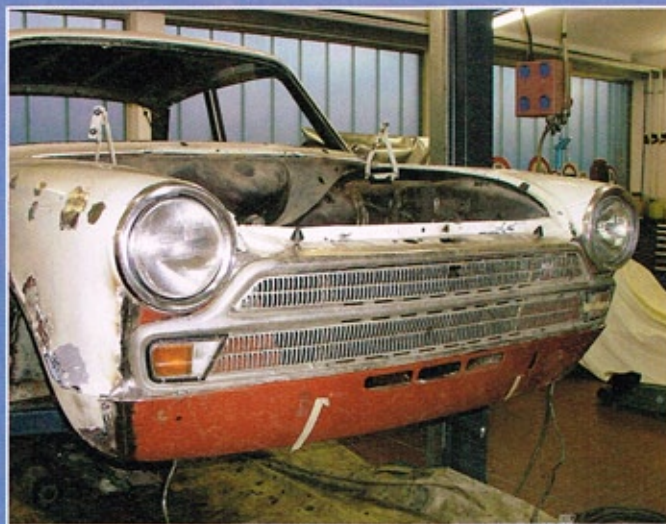
Die beschädigte Frontschürze gab es in England als Reparaturblech. Joachim Ohlinger musste sie nur noch passgenau einsetzen
