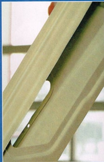
Das Hohlprofil der C-Säule ist schwer zugänglich. Die KTL beschichtet es sogar von innen!
