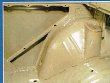
Hinter das Radhaus dringt kaum eine Lackierung richtig vor, jetzt ist der Bereich gut geschützt
