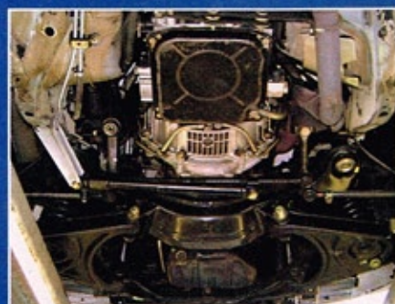
Auch Motor und Getriebe nehmen es nicht krumm, wenn sie mit Eis gereinigt werden
