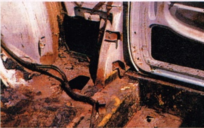
Schon vor dem Strahlen machte die Bodenpartie des T-Bird keinen sonderlich guten Eindruck: Jede Menge schwarze Farbe...
