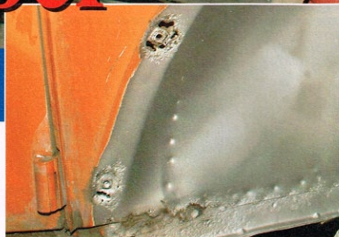
Wenn es dem Rost an den Kragen gehen soll, ist aggressives Strahlgut gefragt. Hier war es Glaspudermehl
