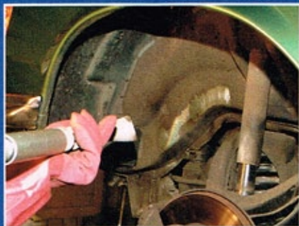
Bei richtiger Einstellung trägt die Eiskanone nur die Unterbodenschutzschicht ab
