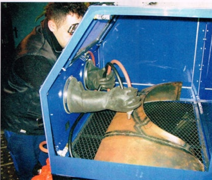
Größere Strahlkabinen bieten auch schon mal Platz für Karosserieblech. Aber auch ihre Domäne liegt eher beim schnellen Freiblasen der verschiedensten Fahrzeugteile, die im Laufe einer Restaurierung so anfallen
