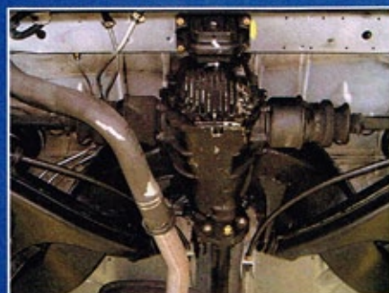
Hier wurde der Bereich über der Hinterachse gestrahlt, die Achse selbst aber nicht
