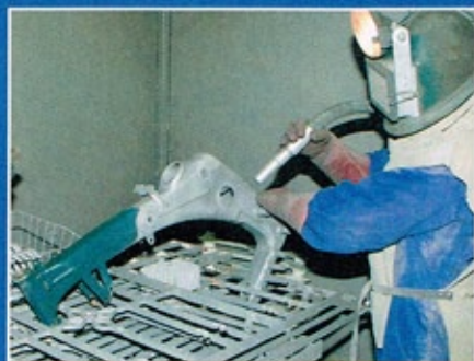
Stabile Teile wie dieser Mopedrahmen vertragen auch schon mal etwas härteres Strahlgut
