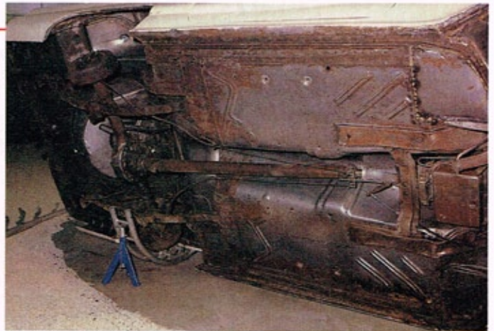
Rost lässt sich mit dem schonenden Verfahren nicht entfernen. Ein großes Plus: Sogar die Phosphatierung des Blechs bleibt erhalten!
