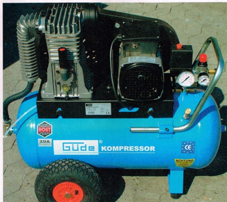
Der Luftbedarf beim Trockenstrahlen ist extrem hoch, deshalb sollte der Kompressor nicht zu klein sein. 350 Liter Abgabeleistung reichen für Hobbyanwender normalerweise aus
