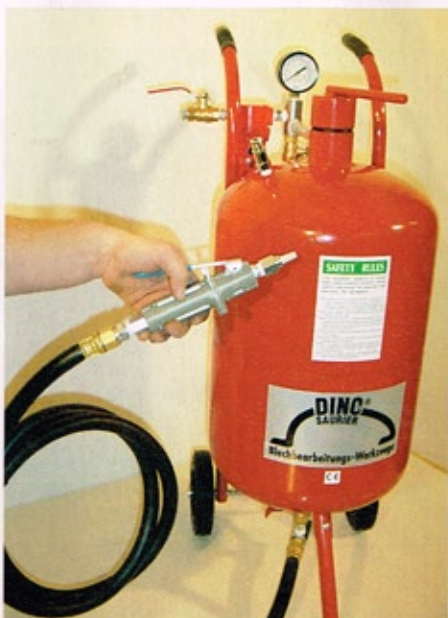
Für Karosserien nicht erlaubt: Freistrahlergeräte sind für den Einsatz unter freiem Himmel konzipiert
