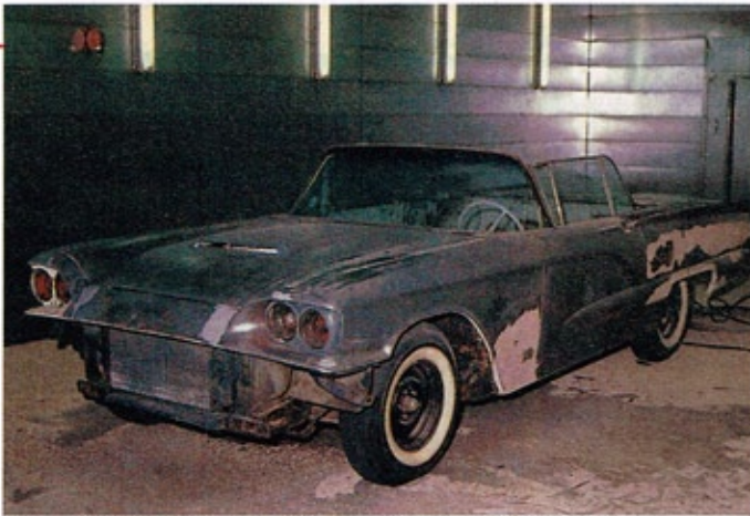
Dieser Thunderbird wurde mit Kunststoff gestrahlt. Der Lack ist ab, und leider zeigen sich nun jede Menge Spachtelstellen
