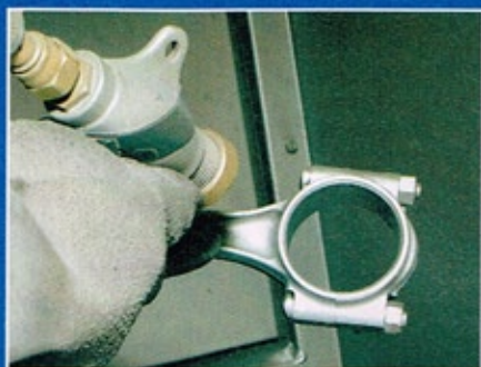
Kugelstrahlen kann Motorteile durch Oberflächenverdichtung bruchfester machen
