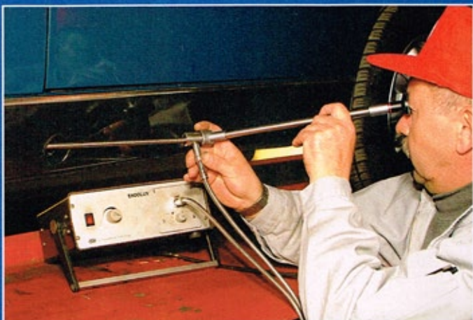
Die Sonden zum Einspritzen in die Hohlräume gibt es in verschiedenen Längen
