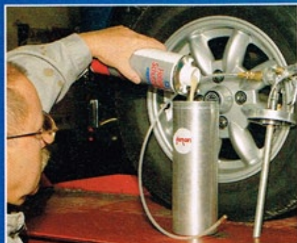
Nun wird das HT-Hohlraumwachs in den Becher der Fertan-Spezialpistole eingefüllt
