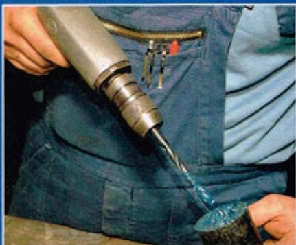
Trick 17: Wenn man den Bohrer in Fett taucht, fallen keine Späne in den Hohlraum
