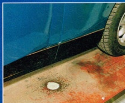
Unvermeidlich: Etwas überschüssiges Wachs tropft aus den Ablauflöchern auf den Boden
