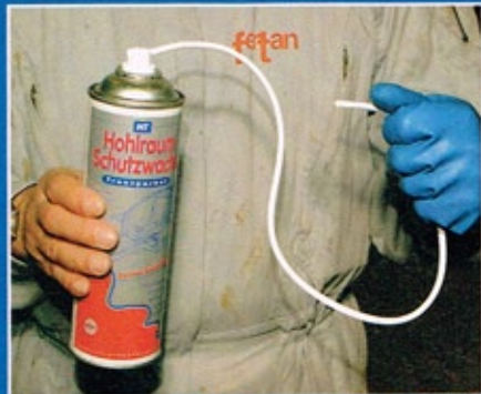
Für schwer zugängliche Stellen eignet sich die Vier-Millimeter-Sonde der Sprühdose besonders
