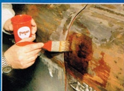
Nun wird Fertan mit dem Pinsel auf die zuvor entfettete Fläche aufgetragen
