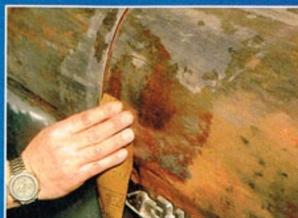
Schleifen beseitigt nur den oberflächlichen Rost, tiefer liegende Poren bleiben unbehandelt
