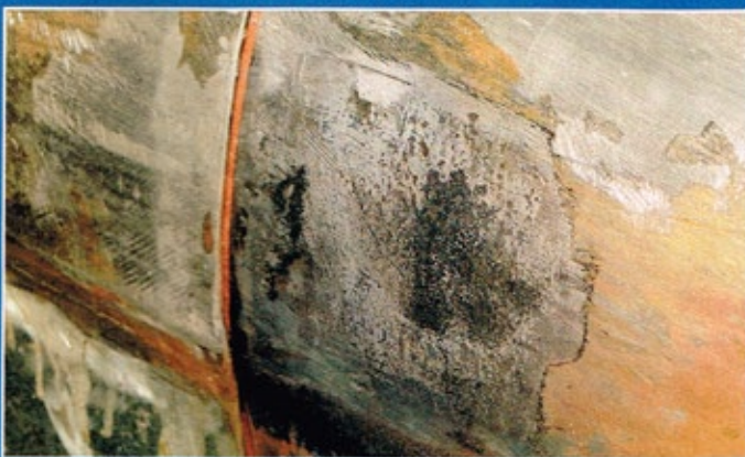
Mit Wasser und einem Schwamm werden nun die Fertan-Reste einfach abgewaschen
