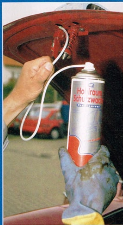
Die dünne Sonde der Sprühdose passt auch in schmale Zugangsbohrungen
