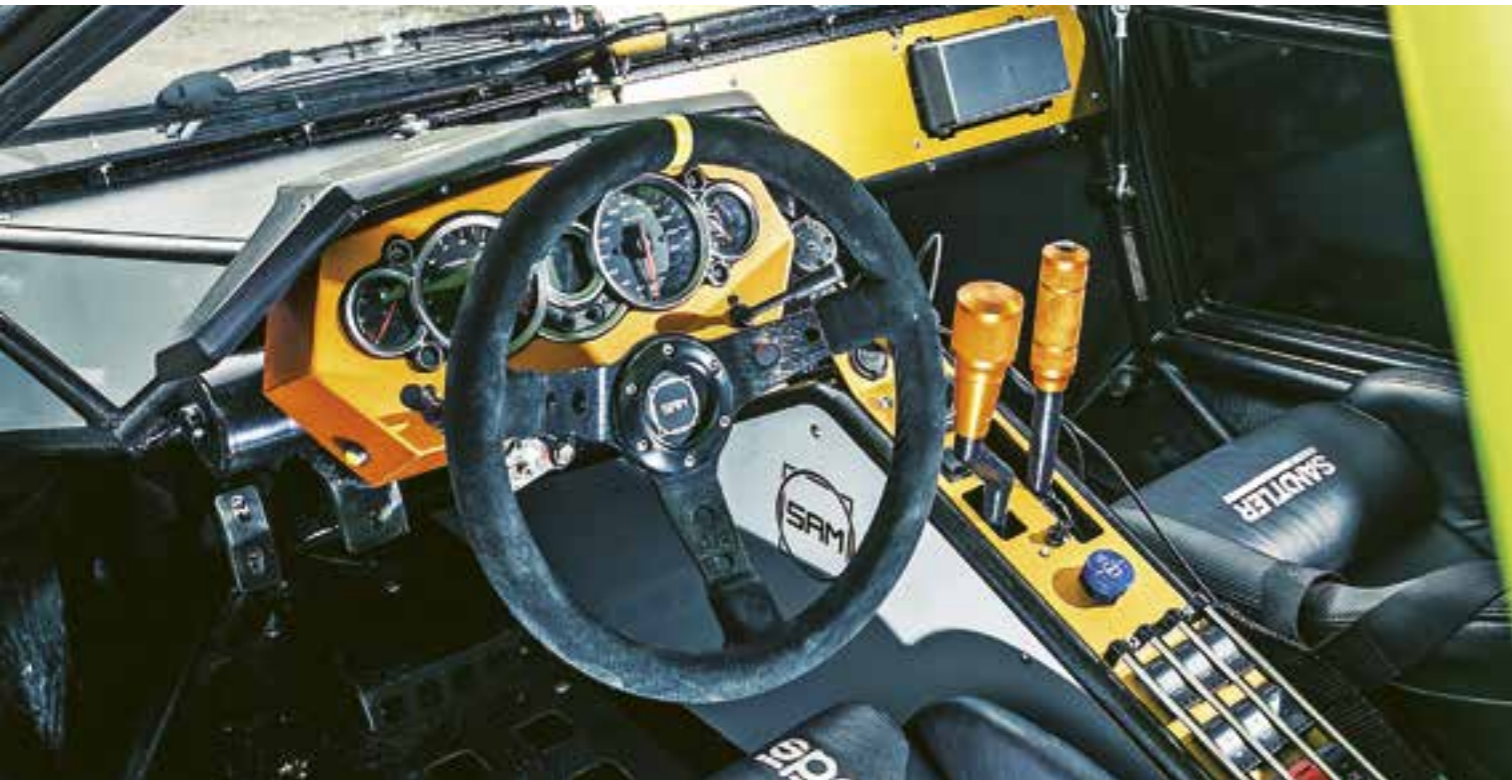
Orange ist im Criog eher Spaß- als Warnfarbe. Der Schalthebel des sequenziellen Getriebes und der hydraulisch betätigte Handbremshebel sind Quellen steter Freude. Das Wildlederlenkrad wird wie bei einem richtigen Rennauto zum Ein- und Aussteigen abgenommen
