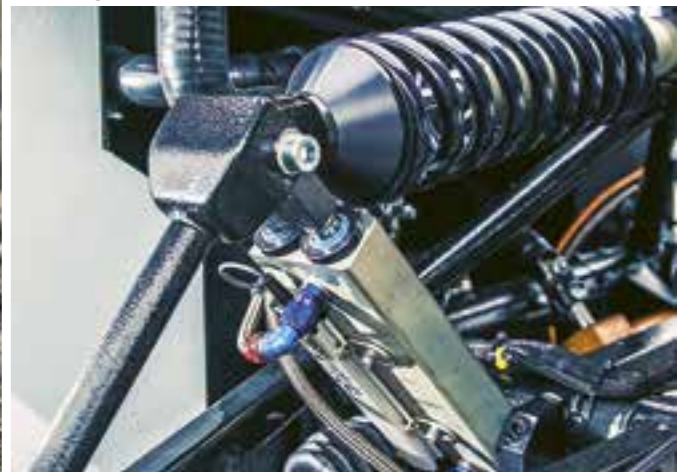
Der „Rocker“ genannte graue Hebelarm macht die Dämpfung bei Absenkung des Fahrwerks härter
