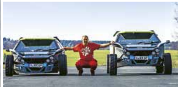
Die Bodenfreiheit variiert dank verstellbarem Fahrwerk: auf Knopfdruck von 10 bis auf 30 Zentimeter
