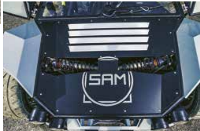
Liegende Pushrod-Dämpfer finden sich sonst eher bei Supersportwagen und Rennprototypen
